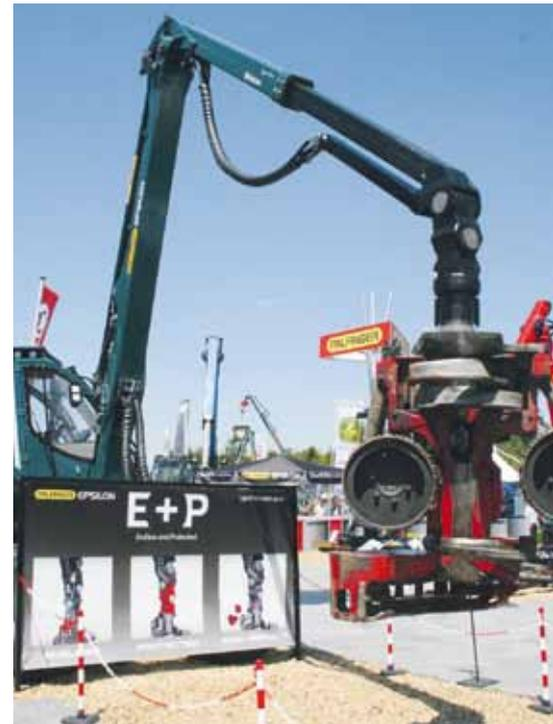
Neuer Harvesterkran M160H100EP von Epsilon ist mit Endlosrotator sowie ausschließlich innen liegenden Schläuchen zwischen Kranarmspitze und Aggregat ausgestattet (Premiere: KWF-Tagung)
