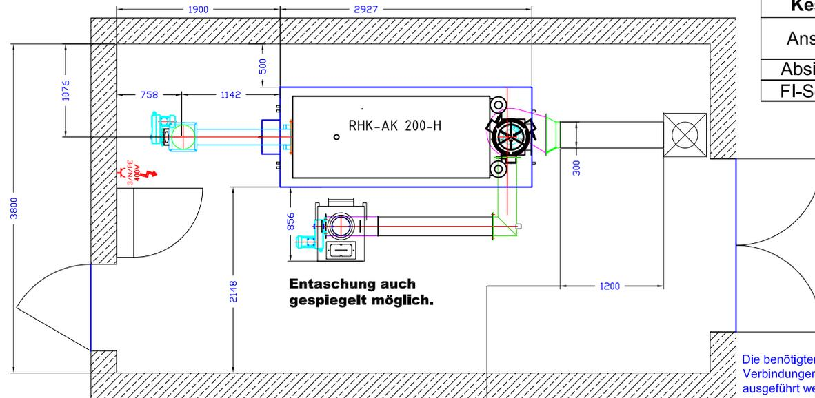
Die benötigte gerade Messstrecke beträgt bis 75 kW 1000mm und ab 100 kW 4x RR-Ø aber min. 1000mm.
