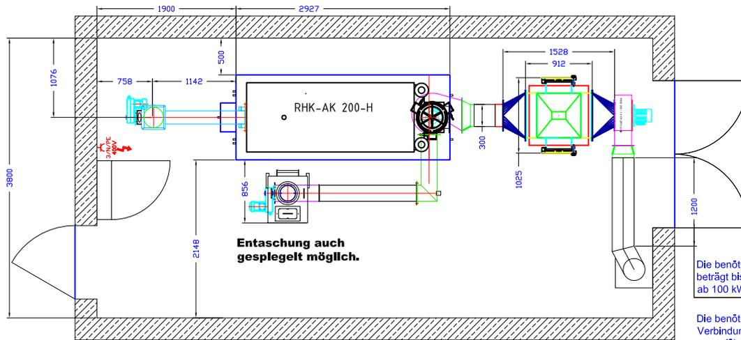
Die benötigte gerade Messstrecke beträgt bis 75 kW 1000mm und ab 100 kW 4x RR-Ø aber min. 1000mm.
