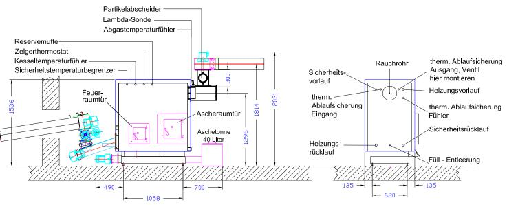
Der Kessel sollte von drei Seiten zugänglich sein, die Austragungsschnecke sollte den Heizraum nicht durchschneiden. Raumhöhe und Position des Multizyklons\* nach Rücksprache mit dem Heizomat-Fachberater.
