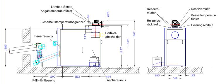
Die Abgasanlage muss kondensatbeständig sein und wird unter Umständen in einer feuchten/nassen Betriebsweise betrieben. Der Kessel sollte von drei Seiten zugänglich sein.
